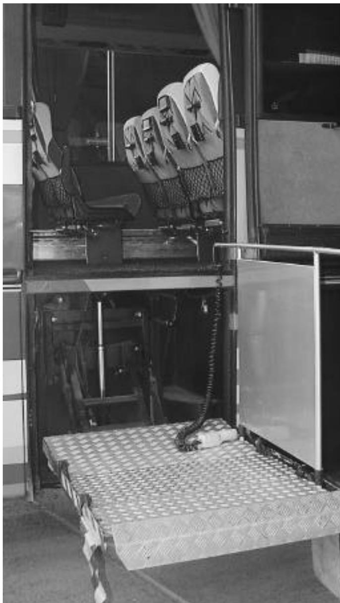
Der Bevo-Bus verfügt über eine grosse dritte Türe, die selbst Elektrofahrstühle passieren lässt. Foto Leuthardt
